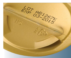
Code noir imprimé par jet d'encre continu sur un flacon de couleur
