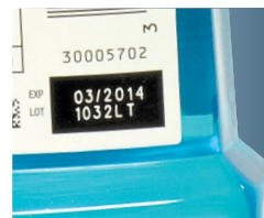
Code imprimé au laser sur une boîte avec ouvertures
