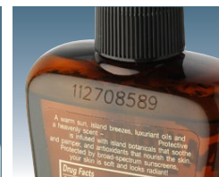
Code imprimé au laser directement sur un vaporisateur
